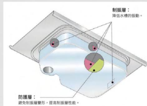
防護層：避免制振層變形，提高制振層性能。
